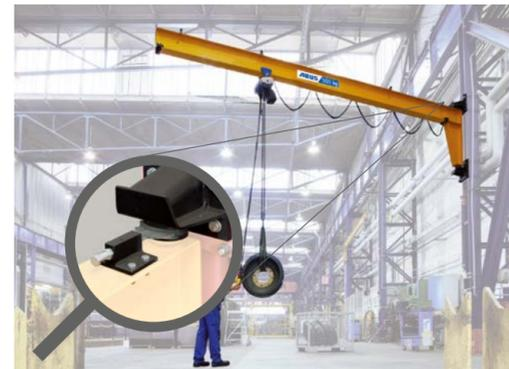
Regulación de resistencia a giro VW (fig. 10)
