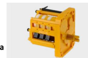
Permite establecer las alturas máxima y mínima del recorrido del gancho. Dos puntos de conexión de serie, situados en la altura de gancho más elevada, garantizan una doble seguridad. Según el caso se puede instalar opcionalmente interruptor de final de carrera de desplazamiento.
