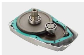
Engranajes planos con dentado oblicuo de funcionamiento silencioso. La construcción ligera facilita el par de impulso necesario para la traslación. Hay cuatro relaciones de transmisión distintas disponibles para cada modelo.
