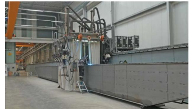
Una vez soldadas las chapas finales y montados los testeros, la grúa se somete al sistema de pintura correspondiente a cada necesidad.
