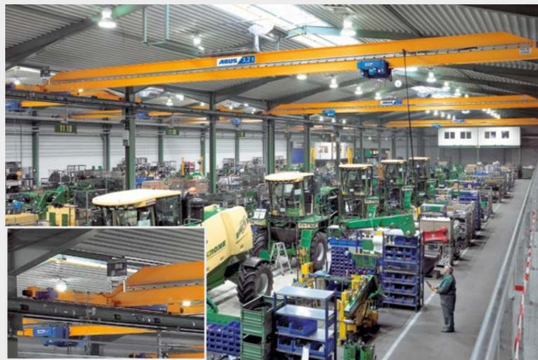
La solución ideal para naves de nueva construcción: El puente grúa monorraíl de ABUS ELK con extremos inclinados para adaptarse a la moldura arquitectónica (variante 3). De esta forma se aprovecha al máximo la altura disponible de la nave.
