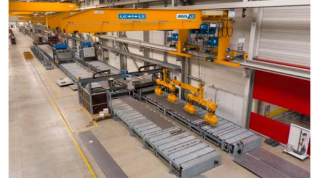
Antes de comenzar el paso siguiente, se estabilizan las almas con rigirizadores longitudinales. La estabilidad total de la forma se logra con chapas de mamparo. Una vez realizado el montaje se prepara la viga cajón para la máquina de soldadura de portales.
