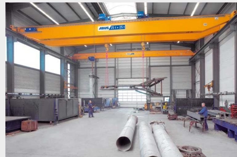
El transporte de cargas pesadas y voluminosas es óptimo cuando se utiliza la grúa con dos carros. El manejo de los polipastos de cable se realiza desde el mando de la grúa de forma individual o conjunta. Un auténtico plus en seguridad para sus labores de transportes.
