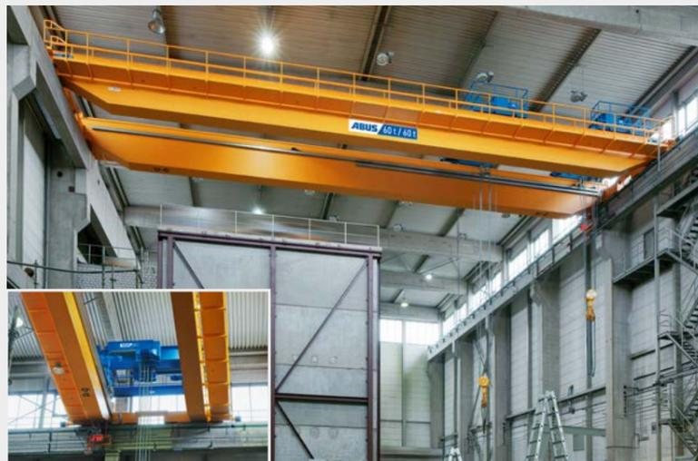
La instalación de testeros de cuatro ruedas permite un adecuado reparto de la carga. Con la misma viga carril se pueden transportar cargas mayores sin tener que reforzar la estructura de las naves.
