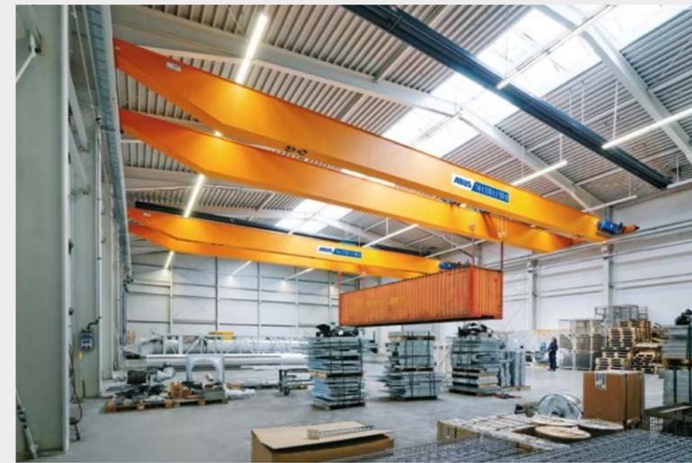
Para transportes de materiales largos y voluminosos, dos grúas en tándem aseguran una manipulación de la carga sin riesgos.
