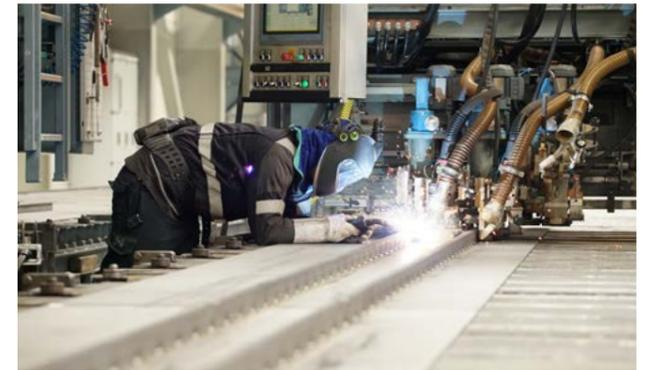
La instalación móvil de soldadura de portales construida por ABUS realiza hasta ocho soldaduras simultáneamente para fijar las almas con los cordones superiores e inferiores y para fijar las guías de los carros en la parte superior de la viga. Los quemadores de alto rendimiento se controlan por ordenador.
