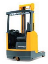
trica; con el pomo de las ruedas de dirección en la posición más ergonómica, la denominada "posición de las 9 horas". Asimismo, destaca el sistema de asistencia Position Control para un apilado fácil y rápido en alturas de almacenaje predefinidas, que con la nueva función integrada "snap", cuando el operario mueve la palanca de cambio. la carretilla reconoce automáticamente el nivel correcto de las estantería. No es necesario seleccionar la altura manualmente.
