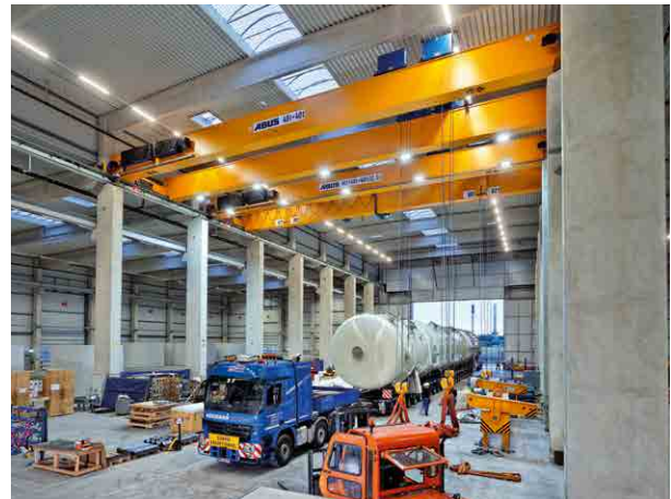
Montaje de grandes máquinas con baja oscilación
