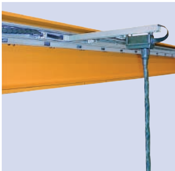
Transmisión de la señal a la botonera
